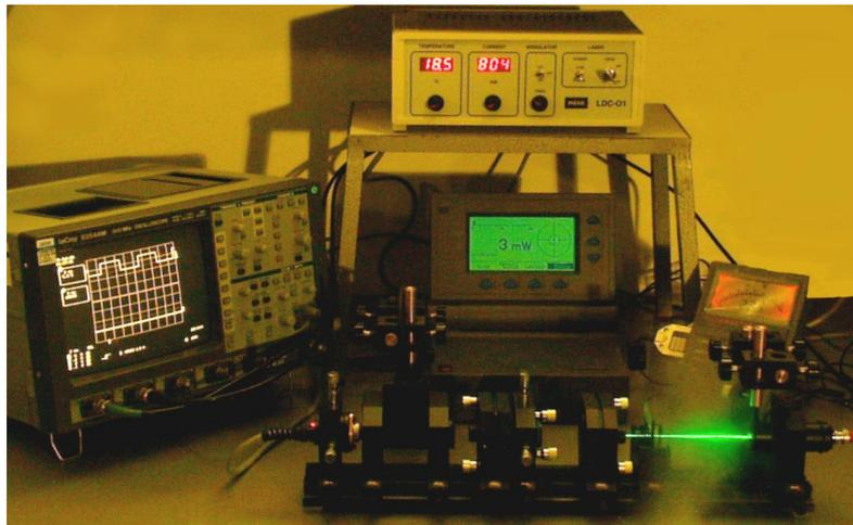
*Versuchsaufbau zur optischen Frequenzverdoppelung: Eine Leistungslaserdiode mit 400 mW bei 808 nm pumpt optisch einen Nd:YAG-Kristall. Dessen Laser-Emission bei einer Wellenlänge von 1064 nm wird resonatorintern frequenzverdoppelt. Licht bei der halben Wellenlänge von 532 nm verlässt als intensiv grüner Strahl den Resonator.*
